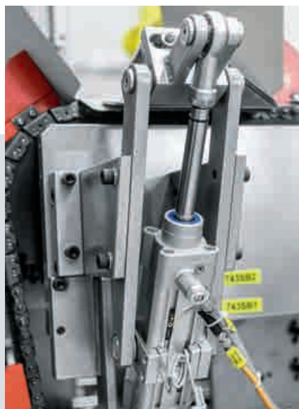
Cilindro estándar DSBC con amortiguación autorregulable PPS que se adapta automáticamente a los cambios de velocidades y cargas.
