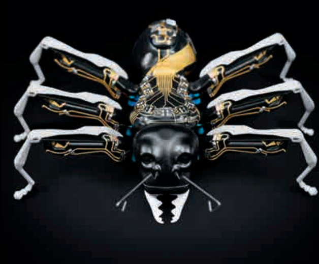
Combinación única: tecnología 3D-MID sobre piezas sinterizadas con rayos láser.
