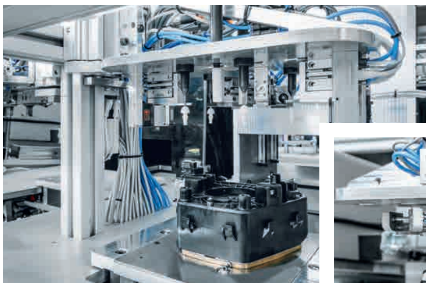
Máquina colocando los elementos de pre-ensamblaje en una pieza destinada a alojar el airbag de un automóvil.
