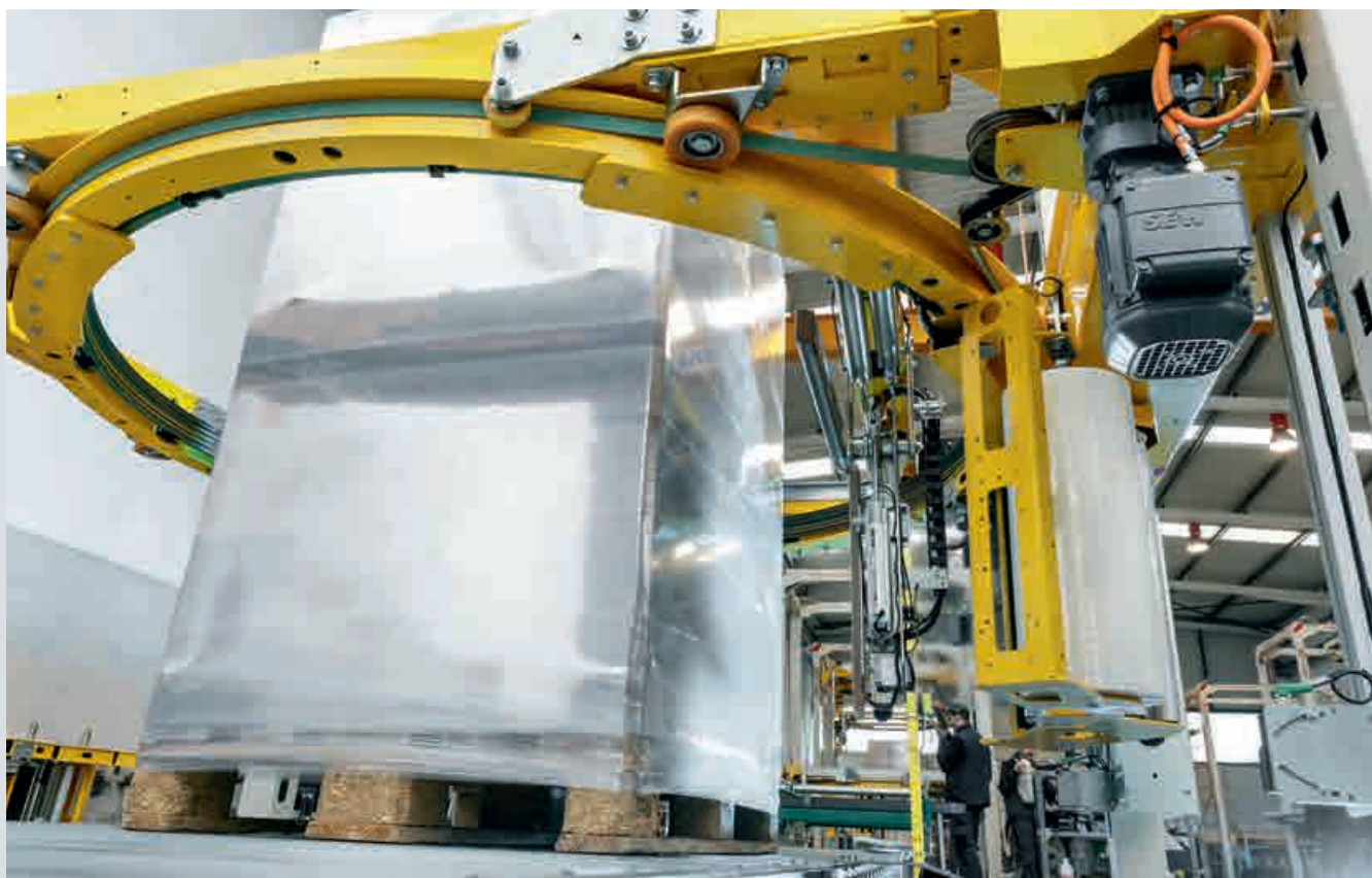
La máquina enfardadora consigue altas velocidades y optimiza el uso del plástico.
