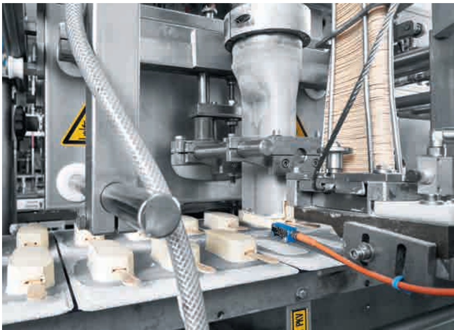
Posicionamiento perfecto: el núcleo de los polos Magnum sale de la extrusora a gran velocidad. Durante el proceso de extrusión, se inserta el palillo.
