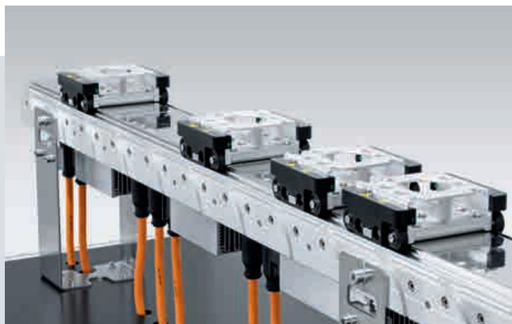
Cambio de formato pulsando una sola tecla: posible gracias al sistema Multi-Carrier.
