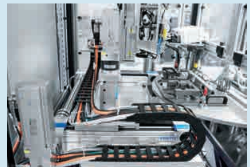
Unidad de manipulación entregada lista para su instalación, utilizada para la aplicación uniforme de una pasta de dos componentes, conductora de calor.
