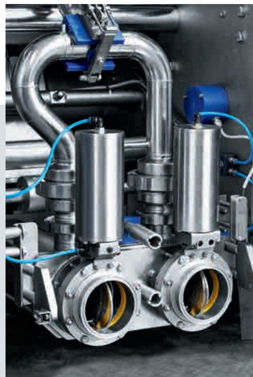
La válvula EvoGuard controla las válvulas de alimentación de queso fresco.
