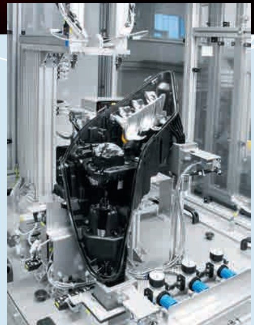
Las unidades lineales y giratorias DSL aplican presión sobre el módulo del faro para comprobar su montaje correcto.
