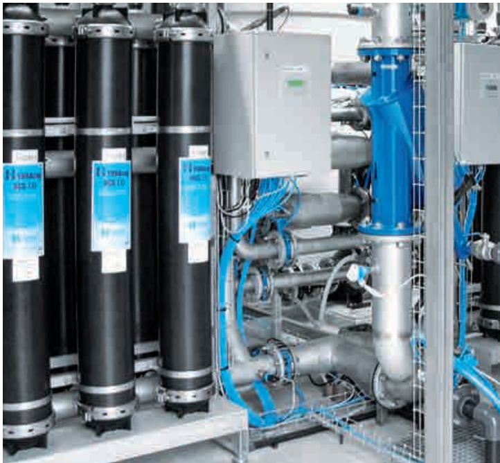
Skids extremadamente versátiles: sistemas de filtración transportables permiten una puesta en funcionamiento muy rápida del sistema de depuración de agua.
