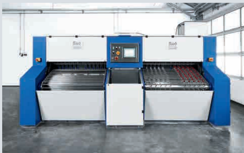
Llenado de 14.500 frutos por hora: la nueva máquina de rellenado de antipastos de Karb Maschinenbau.
