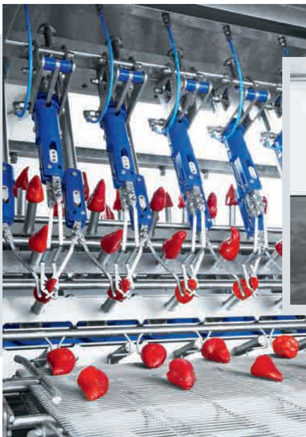
Todo bajo control: las pinzas desarrolladas por Karb Maschinenbau funcionan con cilindros roscados EGZ de Festo.
