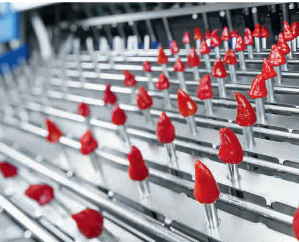
Pimientos formados en fila: los frutos colocados encima de las toberas, a punto de proceder con el llenado de queso fresco.
