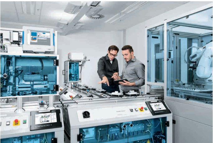
CP Factory: con este completo modelo de fábrica modular y ampliable para la Industria 4.0 es posible reproducir muchas áreas de la cadena de valor añadido.
