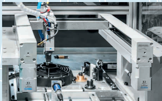
El pórtico horizontal de dos ejes EXCM con espacio operativo rectangular ofrece gran funcionalidad en el menor espacio.
