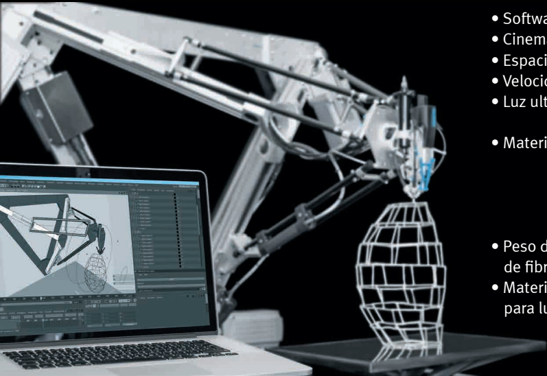
Fabricación digital: el software transmite la geometría de la estructura directamente a las trayectorias de desplazamiento del trípode.
