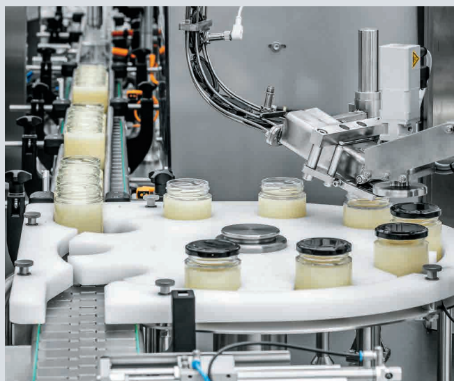
Estación de roscado tapa mediante motor paso a paso junto con eje eléctrico ESBF.
