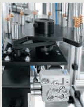
Ejes DGC guían el cargador de cepillos desde el almacén de piezas hasta el lugar de mecanizado.
