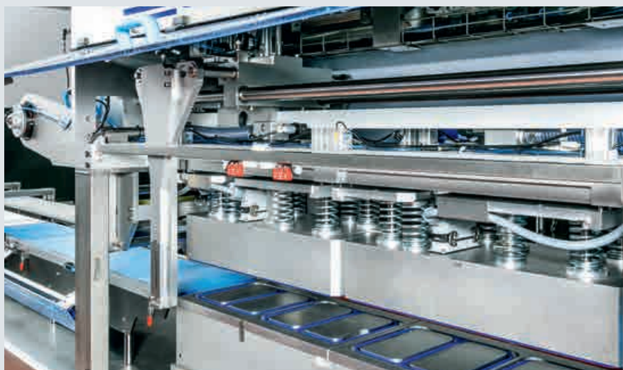
Máquina termoselladora con placa térmica en la parte superior y plataforma que eleva el envase hasta dicha placa. Cuando ambas se encuentran la placa une, a través de calor, una película de plástico con el envase.
