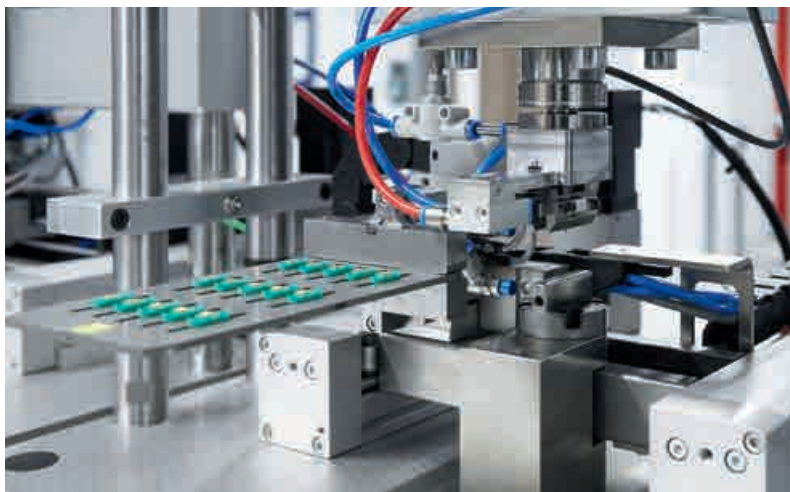
Dinámica y precisión: el sistema de manipulación compacto YXMx se ocupa de los movimientos XY de las piezas bajo la servoprensa.
