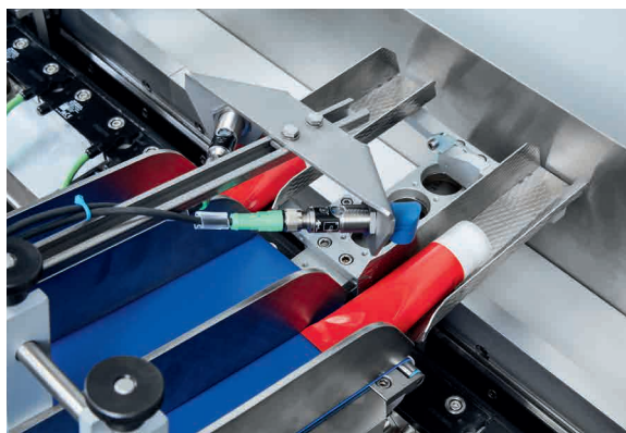
Entrega cuidadosa de los tubos: para evitar que los tubos sufran rasguños o se deformen, el portapiezas se mantiene inmóvil durante toda la operación de carga
