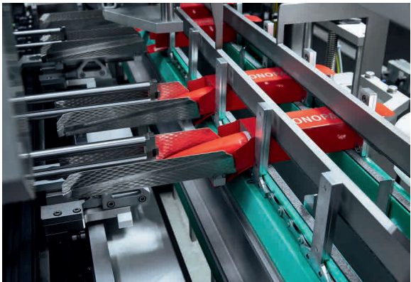
Fase crítica: en ese sector, el MCS y el portapiezas ejecutan un movimiento sincronizado. En el sector posterior se introducen los tubos en las cajas.
