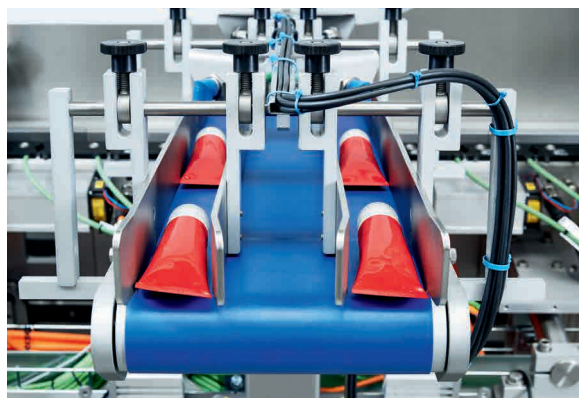
Abastecimiento siempre garantizado: los transportadores de un ciclo de movimiento transportan siempre dos tubos hacia la estación de carga de los portapiezas.
