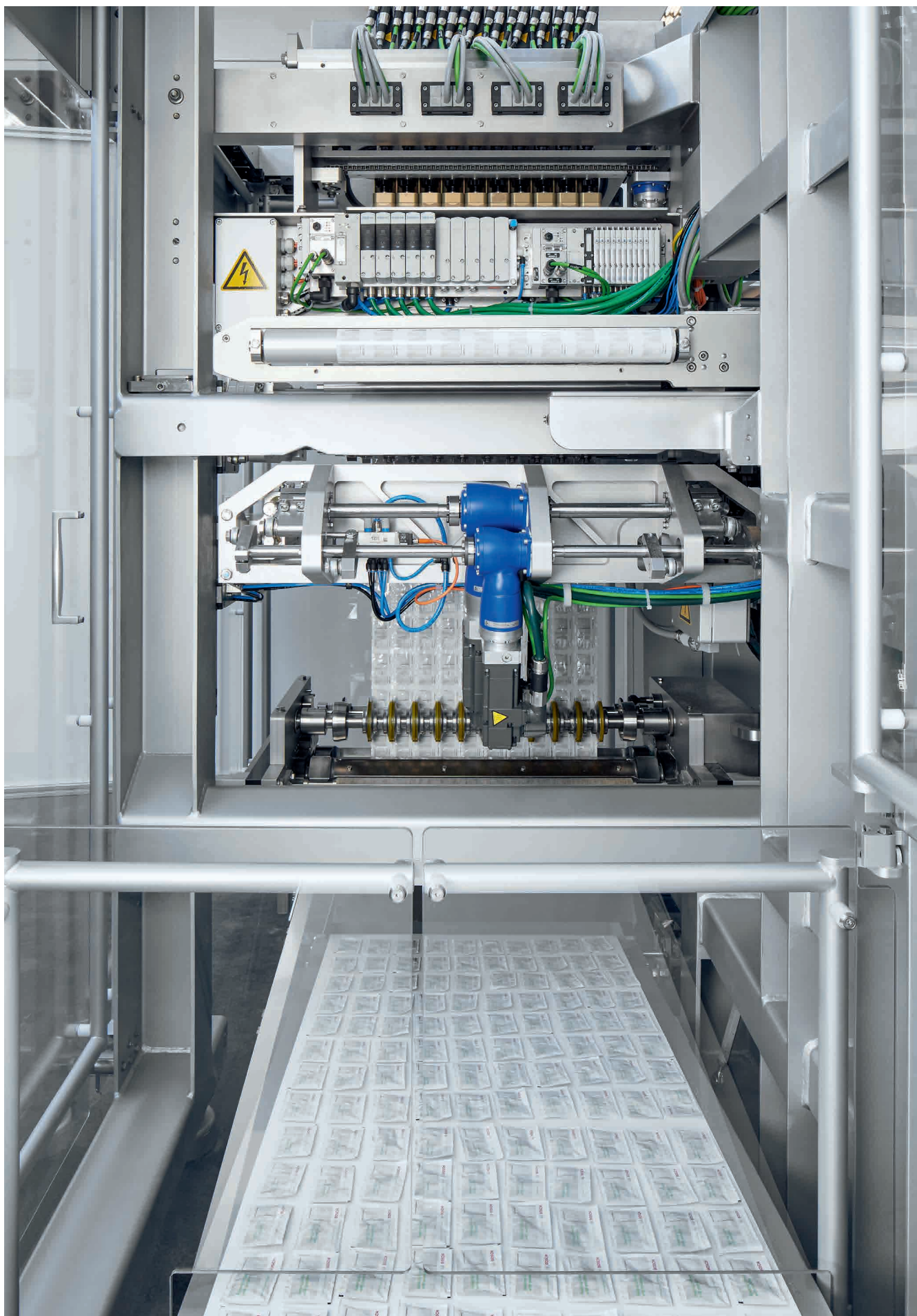
Ajuste rápido y preciso de las cintas, simplemente pulsando un botón: ello es posible gracias a la nueva plataforma de automatización Festo Motion Terminal VTEM, incluida en la máquina envasadora de bolsas pequeñas desechables Sigpack VPF de Bosch Packaging.
