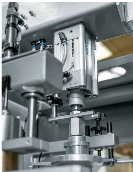
Los cilindros Festo se instalan en las diferentes estaciones de las máquinas de envasado serie FLASH.
