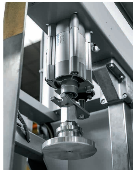
Los cilindros Festo se instalan en las diferentes estaciones de las máquinas de envasado serie FLASH.
