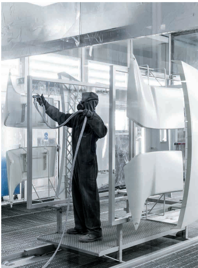
Proceso de pintura de Plásticos Iveco Madrid.
