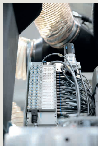
Diseño flexible: los nuevos centros de mecanizado de SCM con cilindros estándar de Festo, controlados por terminales de válvulas VTUG.
