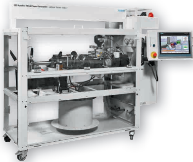
Fiel copia del original: el simulador de una turbina de energía eólica Nacelle®.
