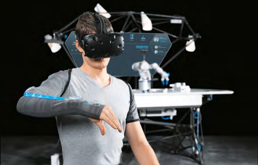
Manipulación a control remoto: trabajar sin peligro alguno a una distancia prudente, con prendas textiles y unas gafas de realidad virtual.
