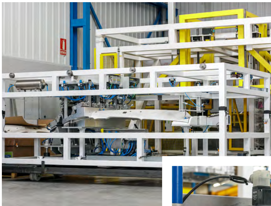
Los terminales MPA-S, admiten hasta 128 bobinas, 64 válvulas
