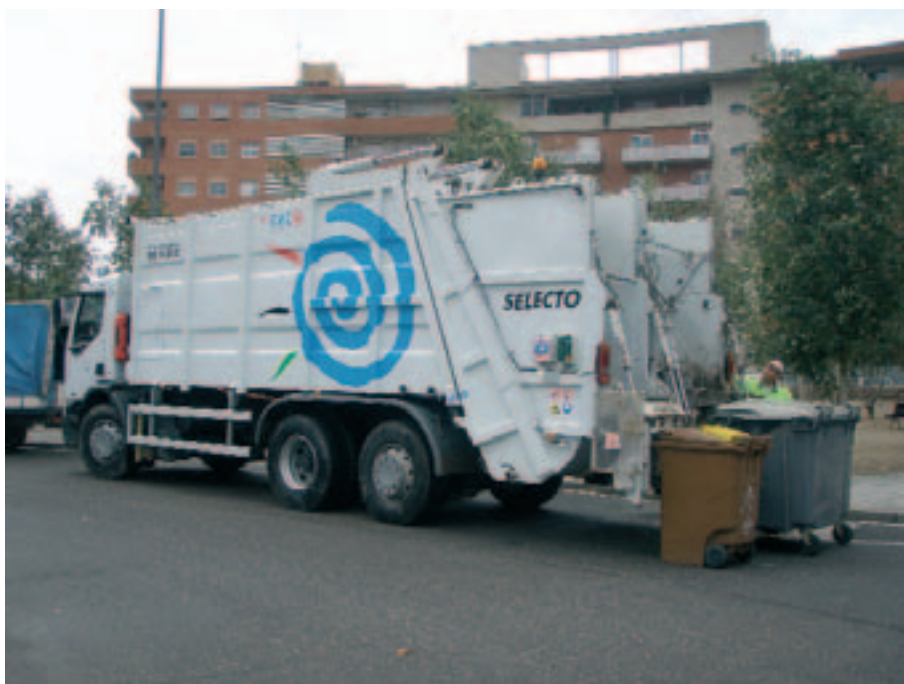
Camió recol·lector de càrrega posterior equipat per dur a terme una recollida bicompartimentada
