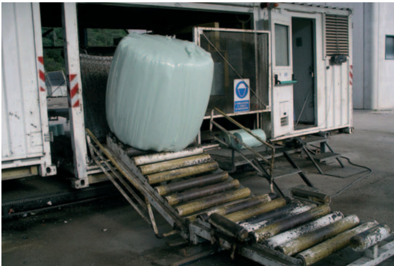
Un cop compactats, els residus són empaquetats en grans bales, en aquest cas cilíndrica, per poder-se dipositar
