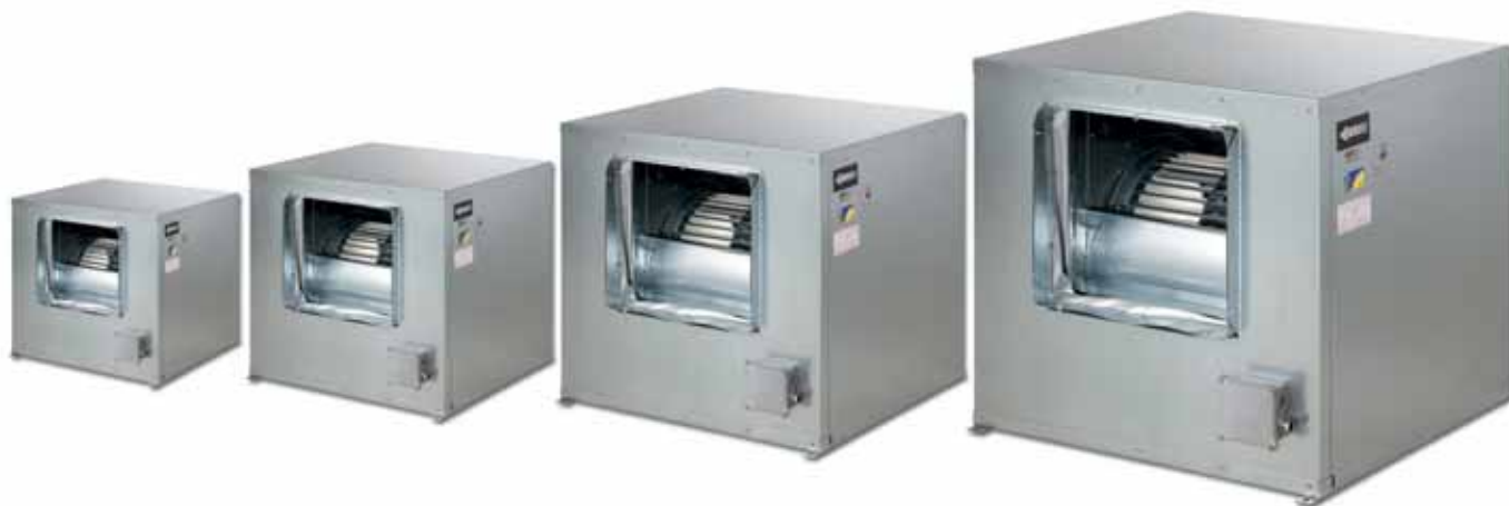
Figura 4. Unitats d'extracció amb caixa aïllada acústicament per treballar immerses en zona de risc d'incendis 400°C/2h i equipades amb motors directes trifàsics o monofàsics
