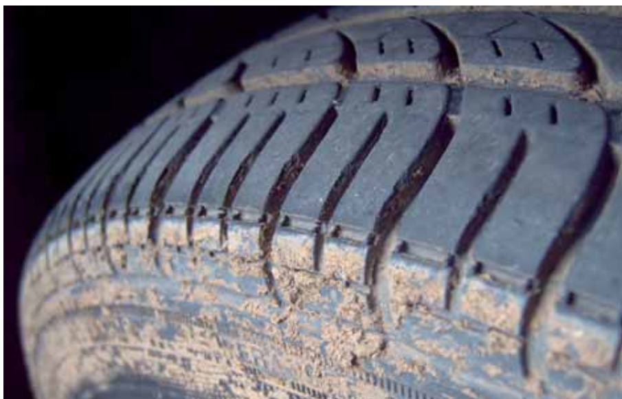
La profunditat d'un pneumàtic nou acostuma a ser de 8 mm. Es recomana substituir-los als 3 mm
